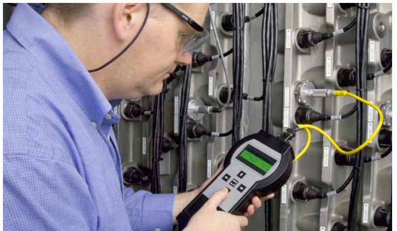
Mit dem Handmessgerät für den UV-Intensitätssensor können Bediener schnell und einfach Soll- und Istwert vergleichen.
