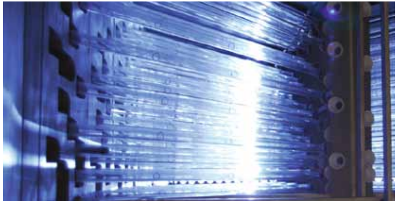
Die abgewinkelte Ausrichtung der UV-Strahler von Trojan reduziert den Druckverlust und optimiert die Desinfektionsleistung. Entwickelt und erprobt für die weltgrößte UV-Desinfektionsanlage zur Trinkwasseraufbereitung.
